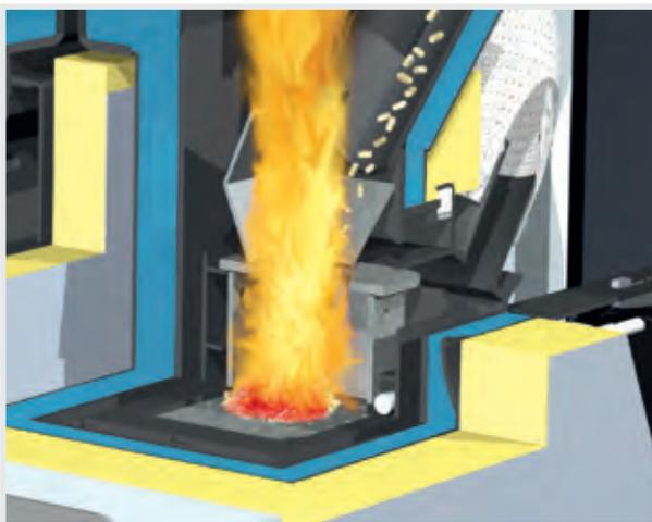
**Merkmal: Wassergekühlter Pelletsbrenner mit automatischem Schieberrost**
